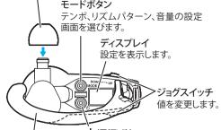
⊕(電源)ボタン 電源をオンまたはオフにします。 イヤーフック 耳にかけて DM-1 を外れにくくします。
